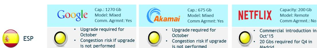
Fig.: Capacidad instalada a nivel de interconexión de la red IP de Telefónica en las CDNs de Google, Akamai y Netflix en septiembre el año 2015. Fuente Telefónica.
