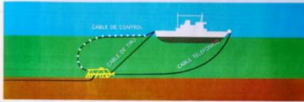
Enterramiento del cable.
